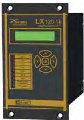
Микропроцессорные устройства LX 120.1k применяются в схемах релейной защиты и автоматики присоединений 6-35 кВ подстанций электроэнергетических компаний, промышленных и сельскохозяйственных предприятий, железнодорожного и городского электротранспорта для защиты от коротких замыканий и перегрузок, а также для управления и телемеханики присоединений работающих с изолированной или компенсированной нейтралью.
